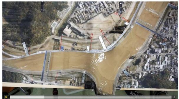
図1. 放水路分派点を再現した 1/1000 の水理模型。画面下への分岐が放水路、左端が狭窄部に当たる。
